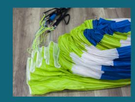
3. SLIDE THE GLIDER IN TO THE BAG AND FOLD THE TRAILING EDGE. USE SPECIAL POCKET FOR THE RISERS
